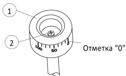
Рисунок 12 – Регулировка указателя положения
