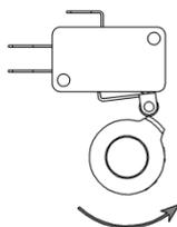
Рисунок 10 – Настройка концевых выключателя положения и сигнализации «Открыто»
