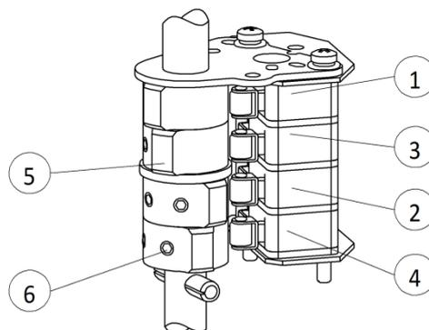
Рисунок 8 – Ограничитель хода с концевыми выключателями
