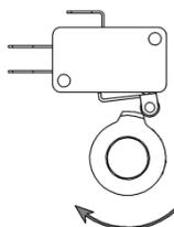
Рисунок 9 – Настройка концевых выключателей положения и сигнализации «Закрыто»
